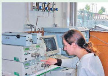
Figura 1.39 Cromatógrafo de gases.
