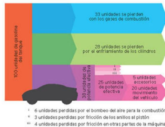
Figura 4.25 Eficiencia actual en la conversión de energía en un automóvil.
