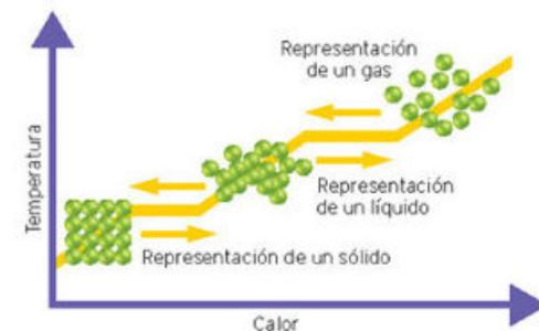
Figura 1.22 Al ganar o perder calor, una sustancia sube o baja de temperatura, pero en los cambios de estado la temperatura permanece constante.
