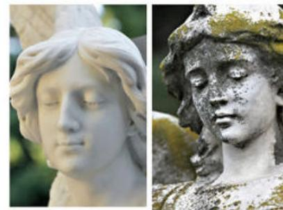
**Figura 4.7** El carbonato de calcio, que es el principal componente del mármol y otras rocas calizas, se descompone lentamente por la lluvia ácida.
