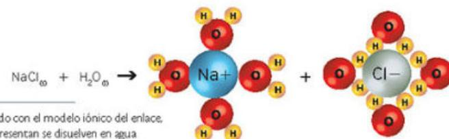
**Figura 4.10** De acuerdo con el modelo iónico del enlace, las sustancias que lo presentan se disuelven en agua formando iones que conducen la corriente eléctrica.
