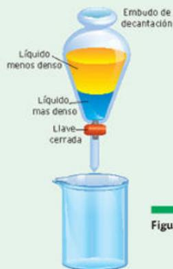
Figura 1.43 Embudo de separación.
